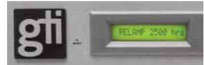
Este monitor de uso de cada fuente de luz se ofrece como accesorio opcional solamente para los modelos con cinco fuentes de iluminación, reemplazando el contador de horas transcurridas.
